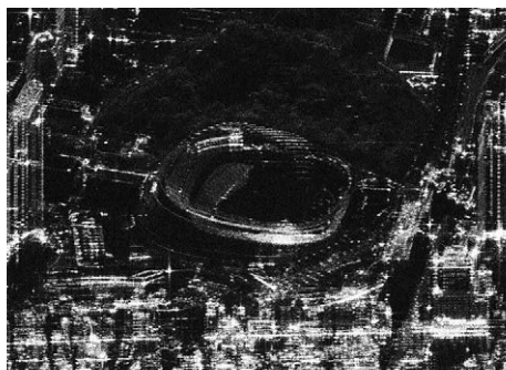
東京ドームの屋根は薄い膜のため、レーダーが透過し、電光掲示板や座席がわかります。 〈東京ドーム付近〉
